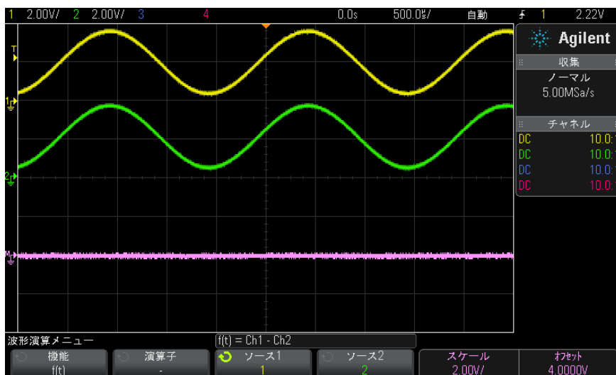
図 5 チャンネル 1 からチャンネル 2 を減算する例
